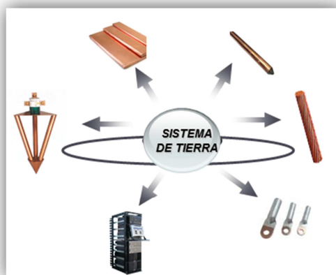
SISTEMA DE PUESTA A TIERRA
